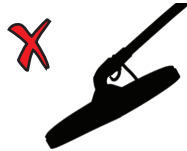
Angle de disque incorrect
